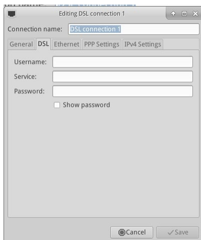
図3-34:DSL サービスのセットアップ
